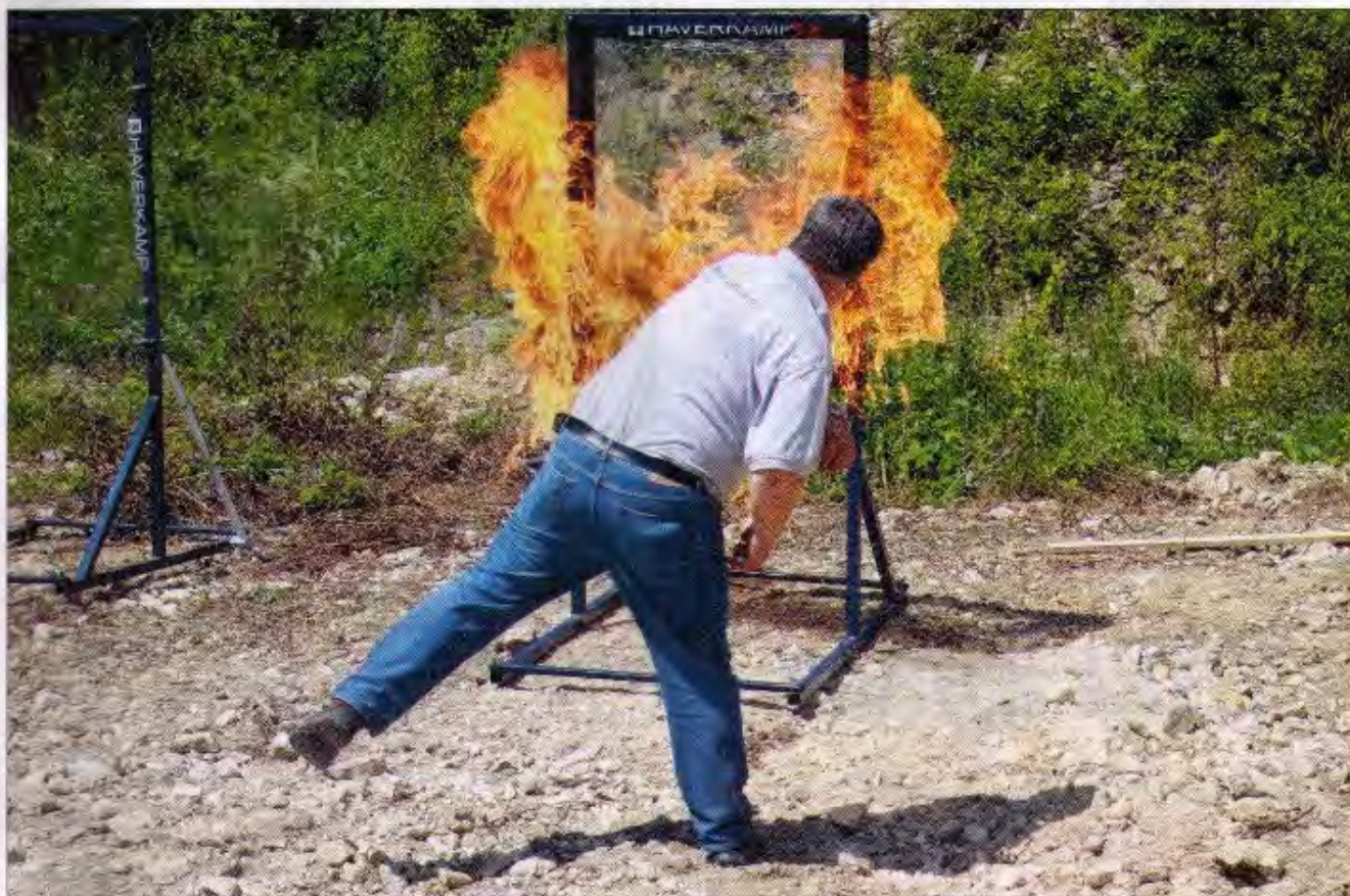
Anschlag im Steinbruch: Fensterfolien halten einer Attacke mit einem Molotow-Cocktail stand.
